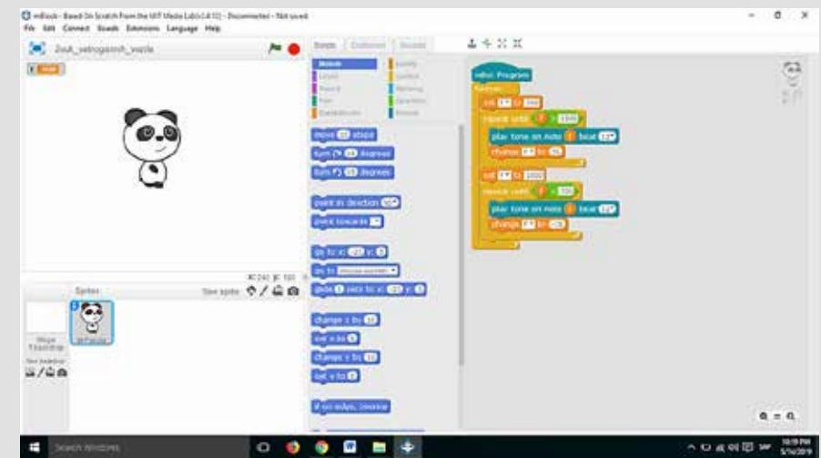
**GRADIJENT SVJETLOSTI** – Napraviti kod kojim će se postići da ugrađena LED lampica svijetli crveno, a svjetlost se postepeno povećava. Kada svjetlost dostigne određenu vrijednost, ugrađena LED lampica se isključuje. Ponovite ovaj postupak.
